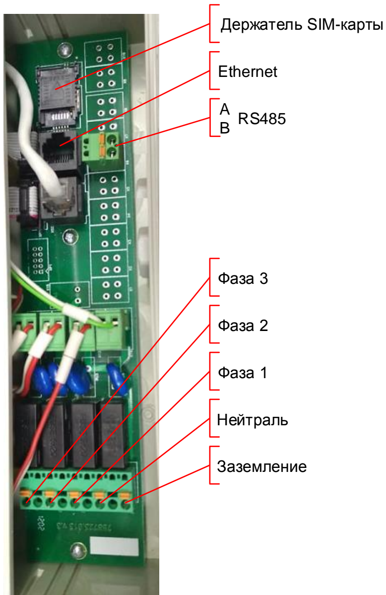
Рисунок В.1 – Назначение контактов разъемов УСПД
